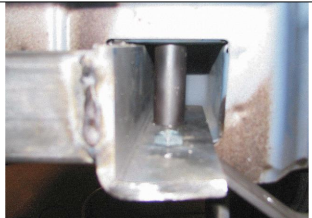
Opvulbuisjes in de chassisbalk - Tubes de remplissage dans la poutre du châssis Filling up tubes in the chassis beam - Ausfüllröhre in Chassisbalken
